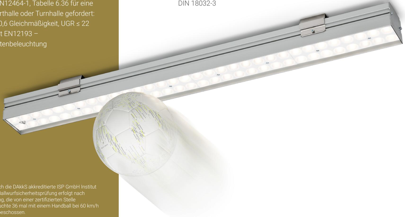
Ballwurfsicherheit geprüft durch die DAkkS akkreditierte ISP GmbH Institut für Sportstätten Prüfung. Die Ballwurfsicherheitsprüfung erfolgt nach DIN 18032-3. Bei dieser Prüfung, die von einer zertifizierten Stelle durchgeführt wird, wird die Leuchte 36 mal mit einem Handball bei 60 km/h unter verschiedenen Winkeln beschossen.
