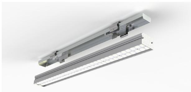
**1.** Montar los dos muelles y encajar en ellos el perfil de base. Hacer la conexión eléctrica.
