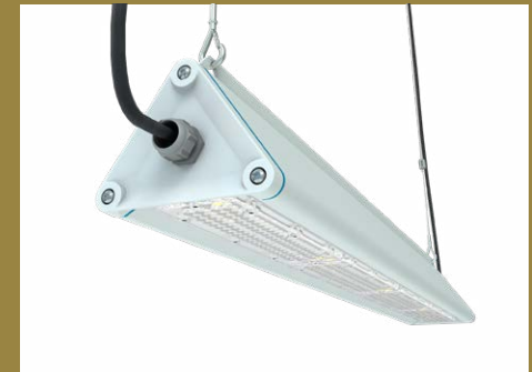
M25 förskruvning i vardera gavel med överkoppling (5 x 2,5mm 2 - L, PE, N, DA, DA).
