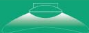
Lente de Fresnel com distribuição luminosa extensiva
