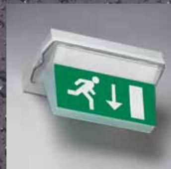
Todas as versões K2 estão disponíveis em LED e fluorescentes, tanto como uma luminária descentralizada (com bateria integrada) ou para uma alimentação de emergência central. Cada K2 descentralizada tem incorporada uma função de auto-controlo. Pode escolher entre uma duração de 1 ou 3 horas.
