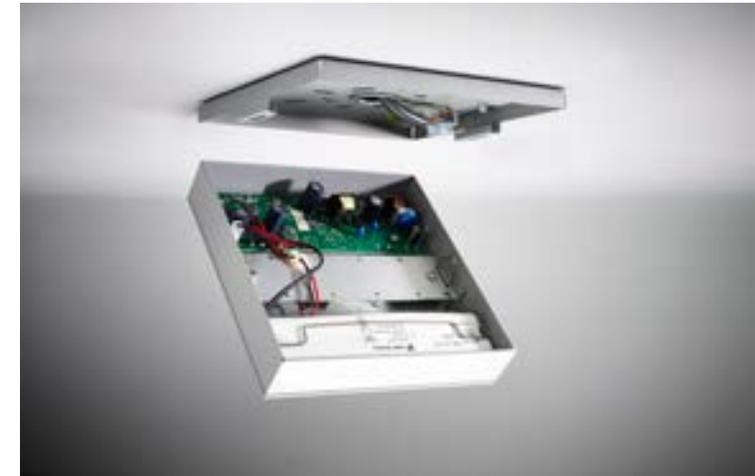
Conexión automática: Las luminarias K9 se abren sin necesidad de herramientas. La propia operación de apertura las desconecta automáticamente de la red eléctrica. De este modo, el mantenimiento sobre el terreno puede realizarse de forma segura.
