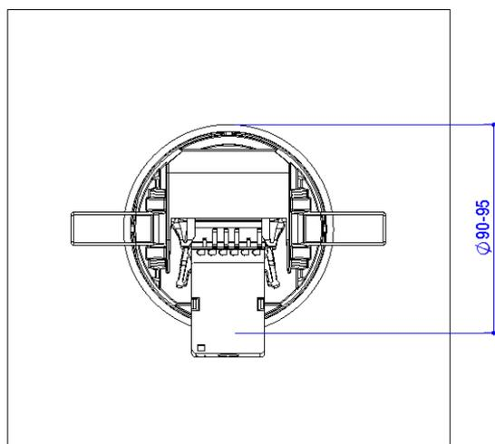
La zone de détection de mouvement est rectangulaire, la vue la plus large étant alignée avec les ressorts, l'axe parallèlement au logo ETAP et aux ouvertures du capteur. Le capteur devrait être monté dans une zone recevant beaucoup de lumière du jour (si présente) et, étant donné qu'il constitue le point de connexion Bluetooth, également à proximité de la zone où une personne aura le plus de probabilité de se trouver afin de contrôler les luminaires via l'appli sur smartphone.
