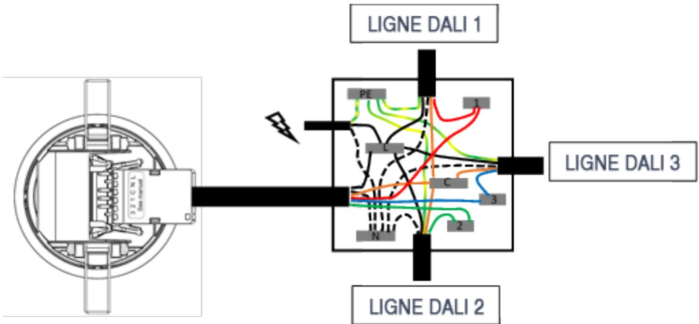
Connexion typique via un bloc de distribution illustrée ci-dessus (les couleurs visent uniquement à clarifier le schéma).
