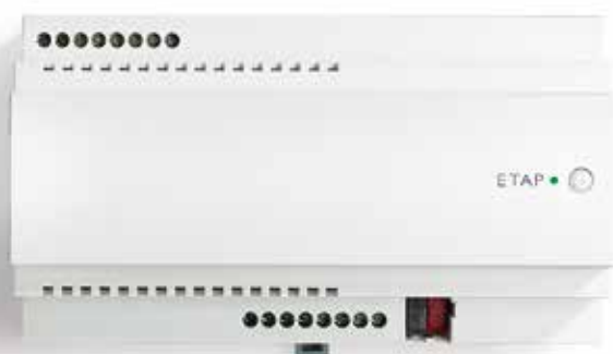
El controlador tiene 4 líneas DALI, cada una de las cuales puede controlar hasta 64 direcciones. Existe la posibilidad de conectar entre sí hasta cinco controladores.
